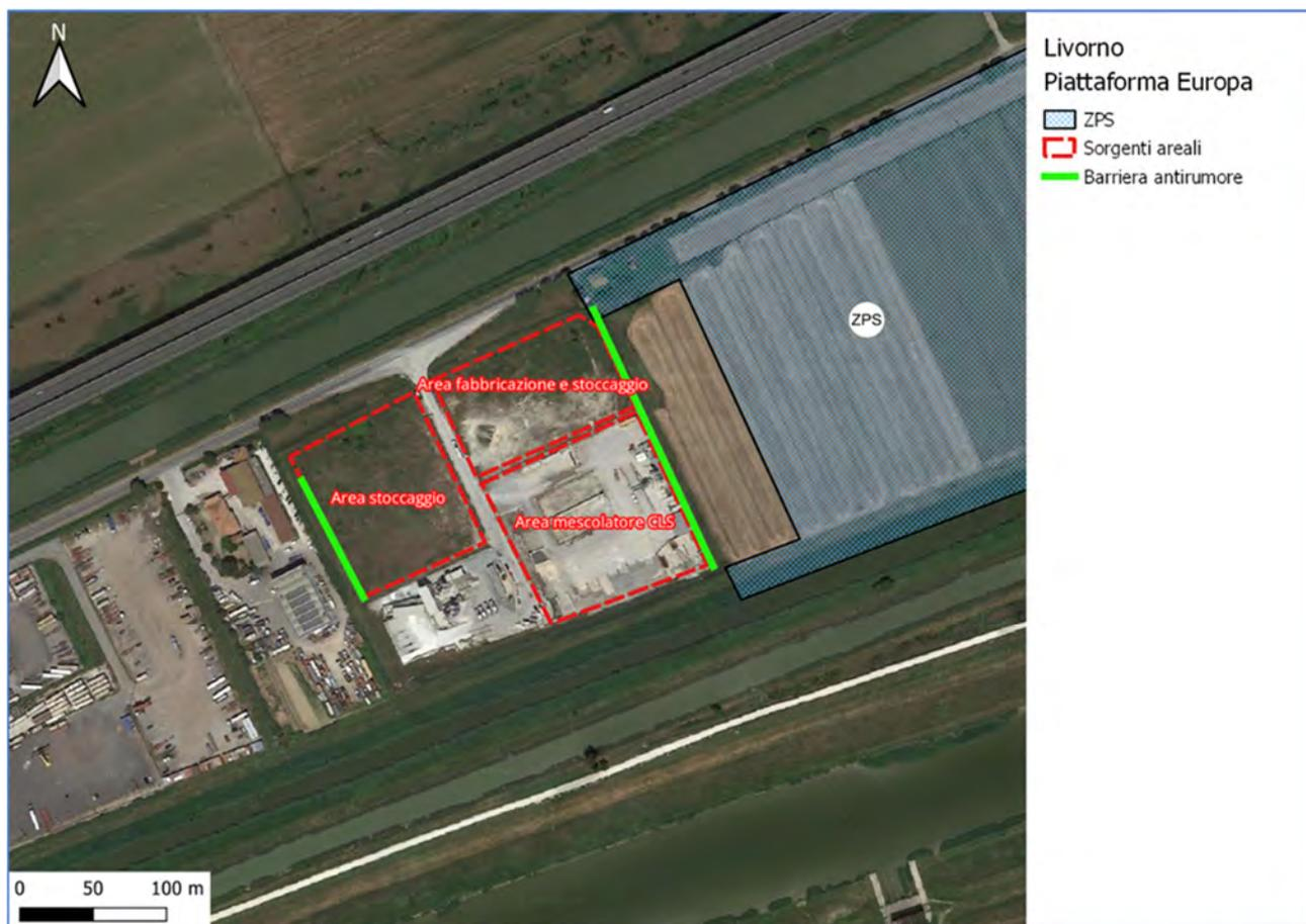
Figura 3-1 Cantiere Biscottino - posizionamento schermatura acustica
