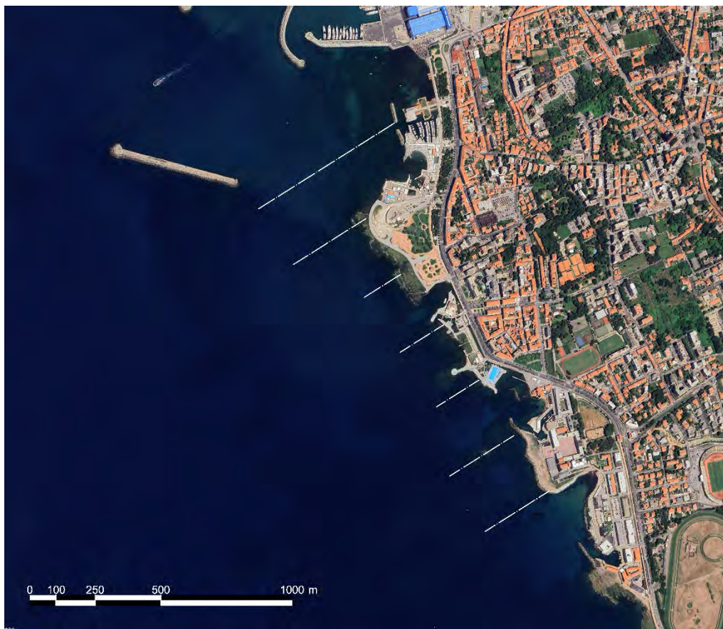
Figura 18-9 - Profili batimetrici previsti lungo il litorale a sud del porto di Livorno
