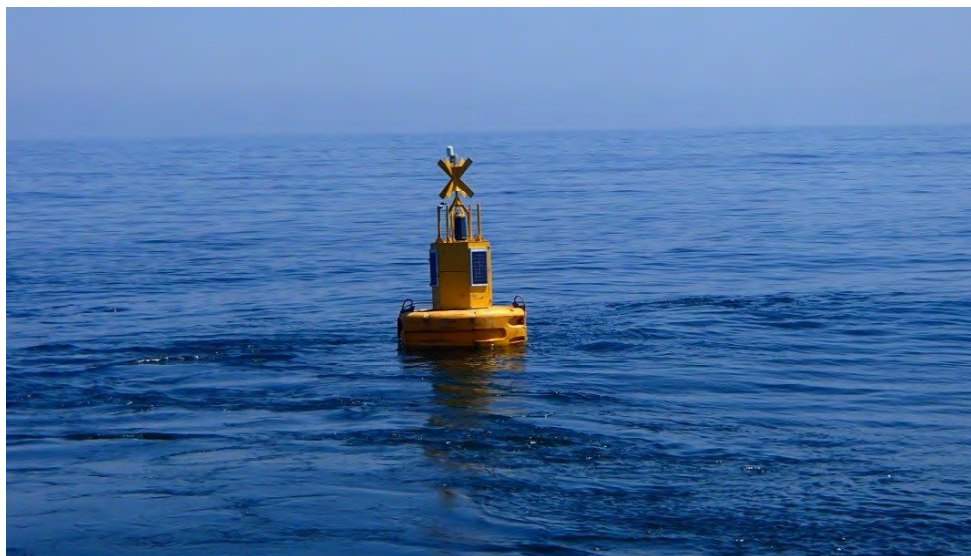
Figura 17-14 - Boa con torbidimetro e pannello solare tipo.
