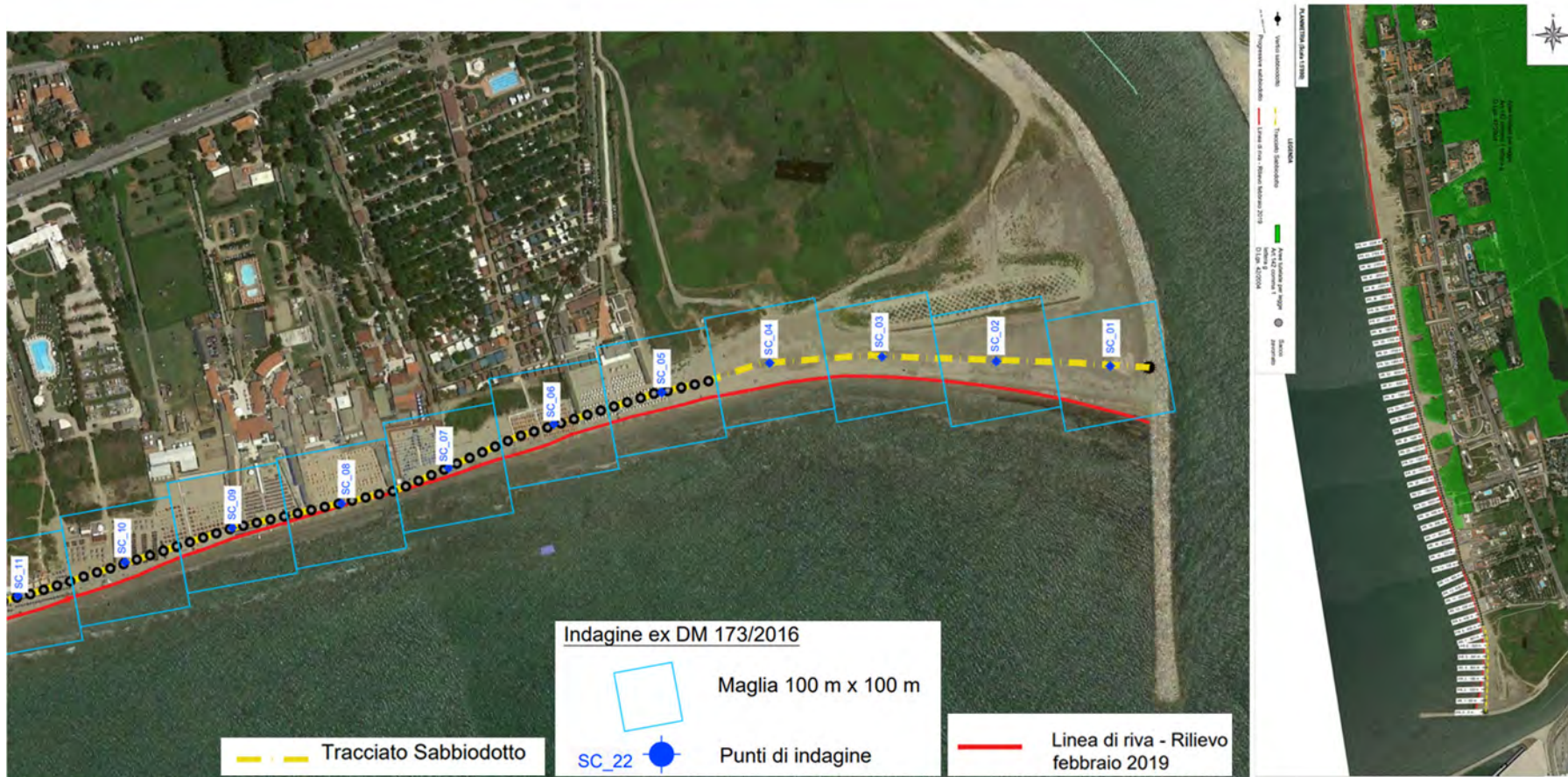
Figura 4-2 - Piano di indagine ex DPR 120/2017 – opera di scavo per il sabbiodotto del Calabrone – Tratto Sud
