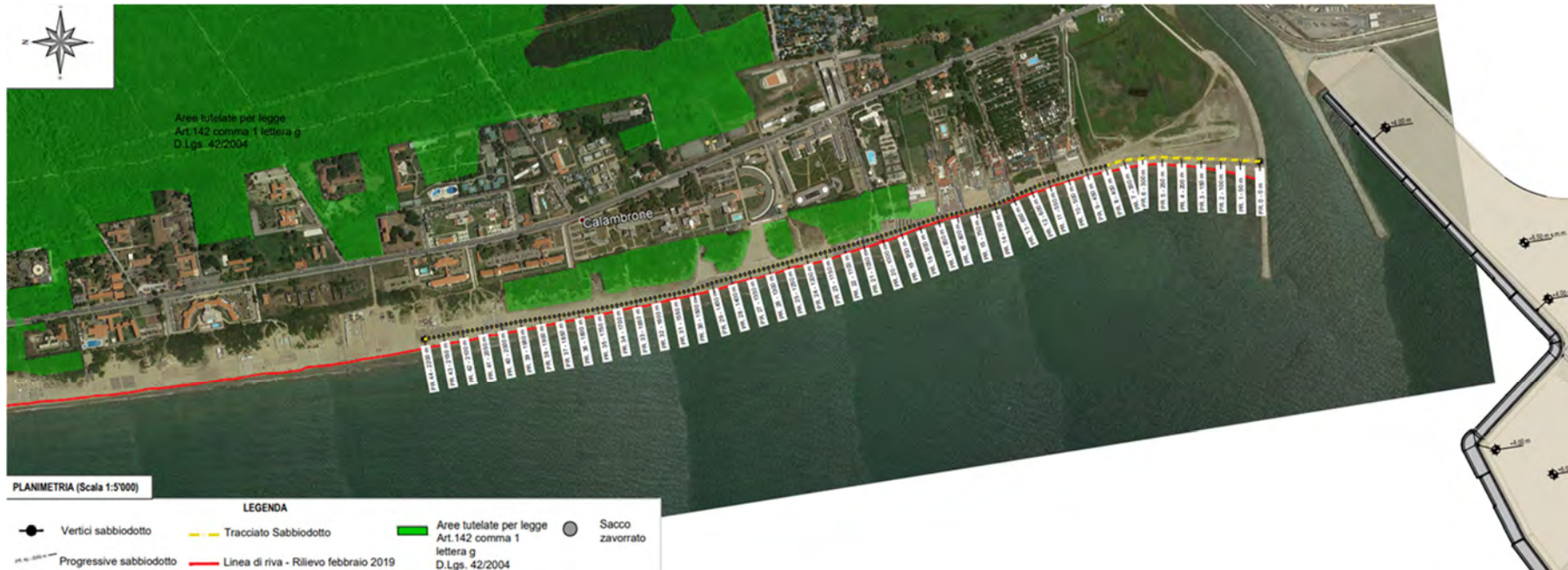
Figura 2-1 - Tracciato del sabbiodotto del Calambrone (opera complementare prevista nel progetto 'Piattaforma Europa')
