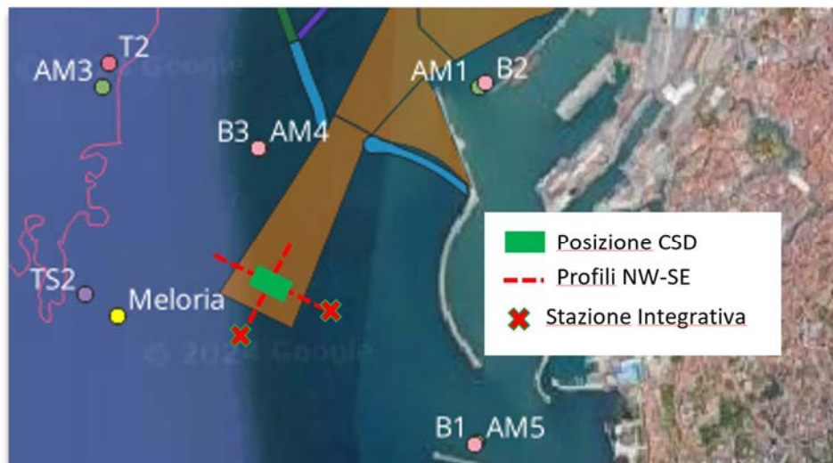
Figura 6-14 – schema operativo del monitoraggio integrativo della torbidità durante le attività di dragaggio idraulico con draga “CSD” (in sovrapposizione alle ulteriori stazioni di monitoraggio previste in CO).
