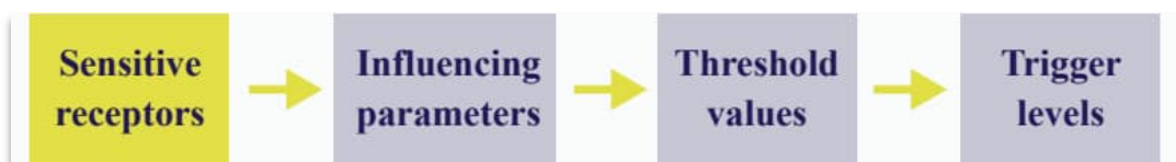
Figura 6-1 – Diagramma di flusso per definire le soglie di allerta sui recettori sensibili
