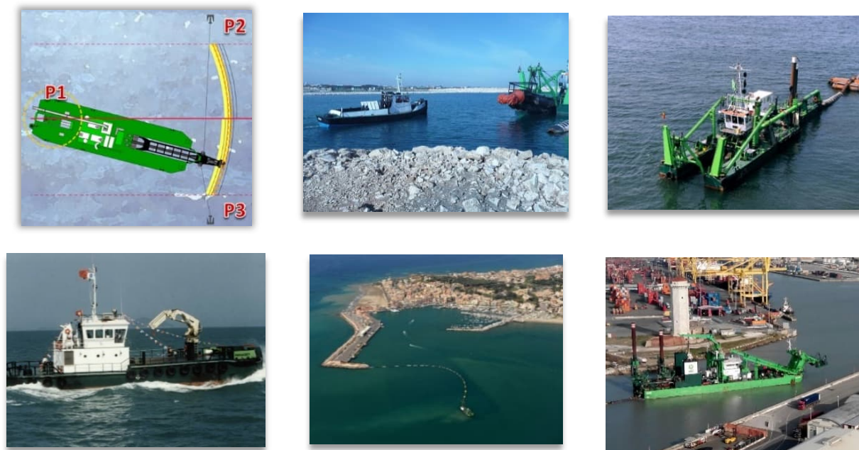
Figura 5-5 – principio di funzionamento operativo del brandeggio di una draga “CSD” ed alcuni esempi dell’impiego del convoglio effossorio semovente con rimorchiatore di assistenza
