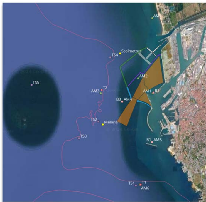
Figura 6-13 – Posizione delle stazioni di misura della torbidità esistenti, delle stazioni aggiuntive e delle trappole sedimentarie come da PMA esecutivo
