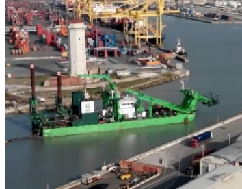
Figura 1-11 – principio di funzionamento operativo del brandeggio di una draga “CSD” ed alcuni esempi dell’impiego del convoglio effossorio semovente con rimorchiatore di assistenza nel porto di Livorno
