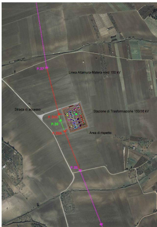
Figura 1: Inquadramento delle opere su Ortofoto della futura SE "Altamura 36 kV" e dei raccordi 150kV alla linea "Pellicciari-Gravina-Altamura"
