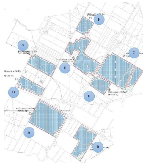
Fig 2: Planimetria di progetto con identificazione dei campi fotovoltaici.
