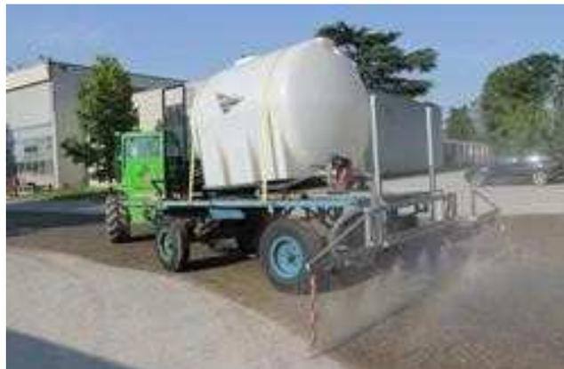
**Figura 22 - Autocisterna dotata di sistema innaffiante**
