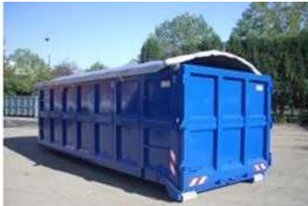
**Figura 16 - Cassone scarrabile a tenuta dotato di telo di copertura**
