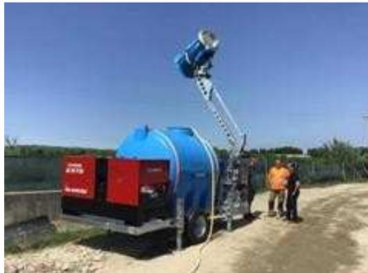
**Figura 21 - Sistema di bagnatura con cannoncino nebulizzatore**
