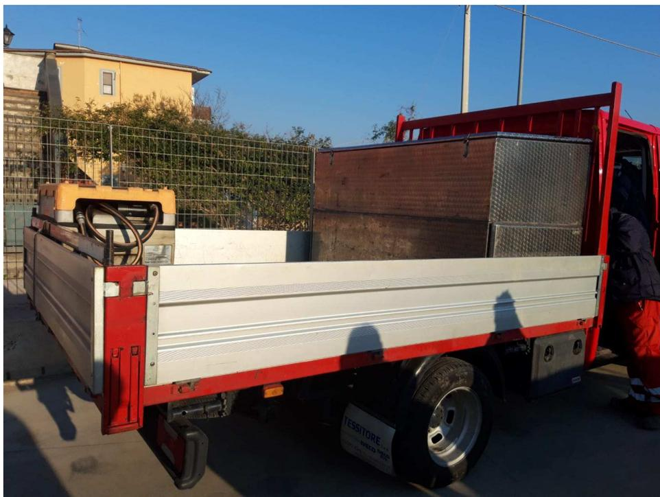
**Figura 20 - serbatoi mobili/trasportabili per il rifornimento dei mezzi di cantiere**
