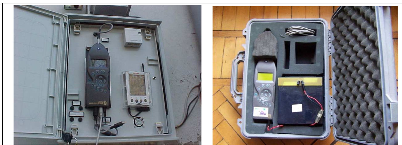
Figura 4-1 - Esempio di strumentazione impiegata per i rilievi acustici
