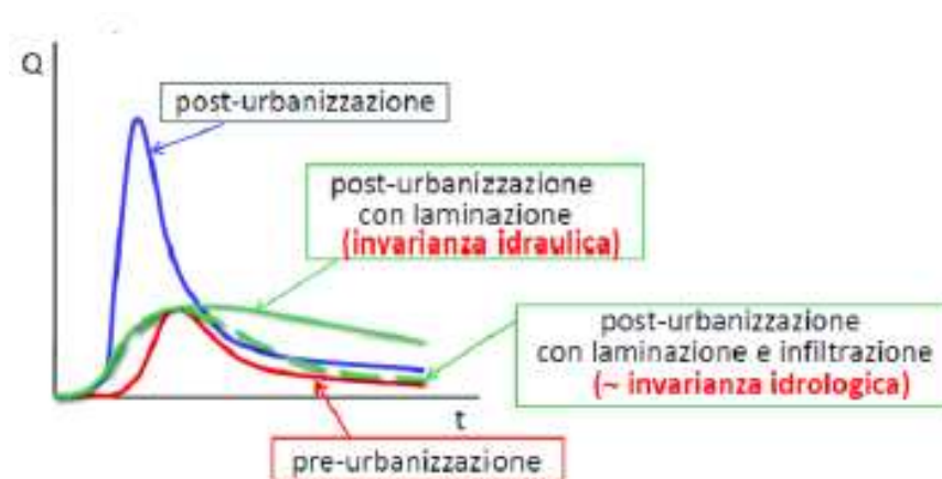
Figura 9-1 - Rappresentazione schematica del concetto di invarianza idraulica (da "Criteri e metodi per il rispetto del principio dell'invarianza idraulica ed idrologica Varese" - Geol. Marco Cinotti - Ing. Alessandro Balbo - Ing. Giacomo Galimberti)
