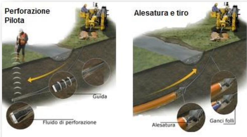
Figura 47 - tecnologia di trivellazione orizzontale controllata (TOC)
