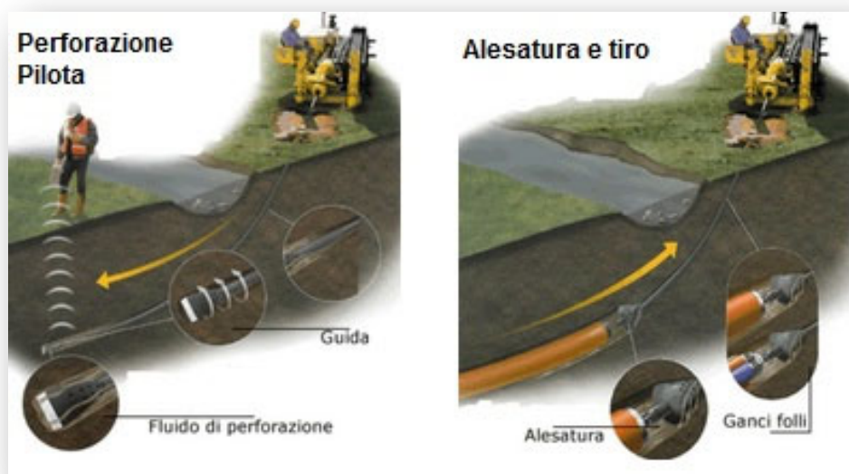
Figura 14 - Tecnologia di trivellazione orizzontale controllata (TOC)
