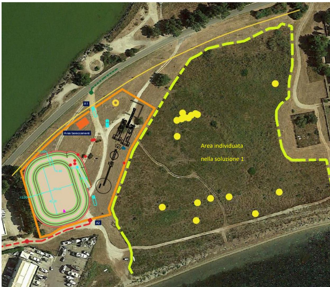
*Figura 12: Localizzazione dell'impianto di trattamento a terra secondo la Soluzione 2 e dettaglio dell'area di cantiere a terra destinata a vasche di colmata e impianto di trattamento delle materie provenienti dagli escavi.*
