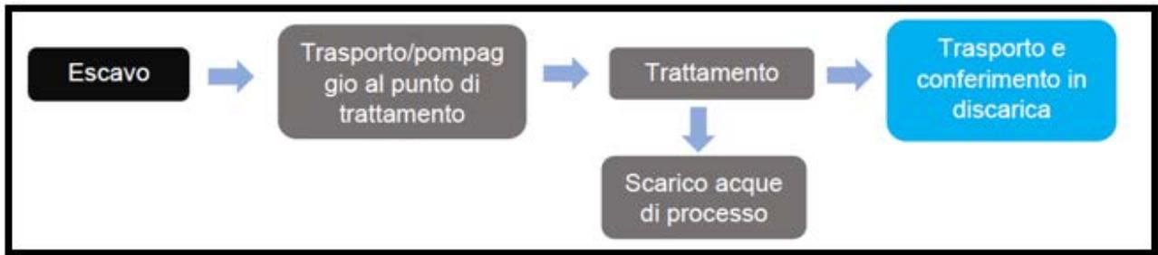
Figura 19: Schema delle fasi del ciclo di dragaggio.
