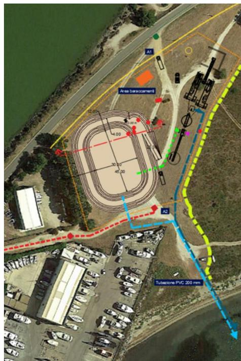
**Figura 6 - Dettaglio dell'area di cantiere a terra destinata a vasche di colmata e impianto di trattamento delle materie provenienti dagli escavi prevista nelle aree esterne adiacenti al porto secondo la soluzione adottata.**
