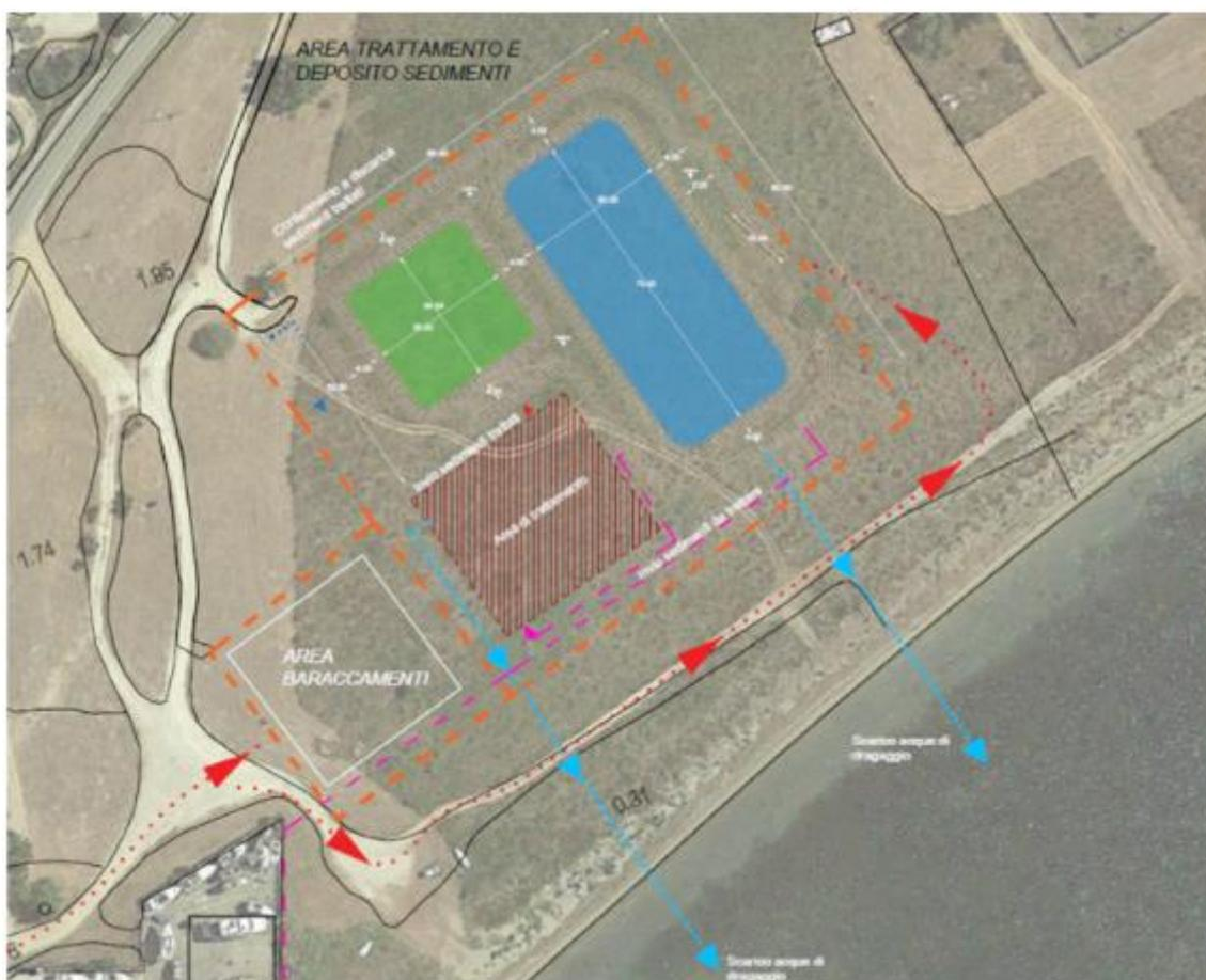
**Figura 4 - Area di cantiere originaria prevista nelle aree esterne adiacenti al porto destinata a vasche di colmata e impianto di trattamento delle materie provenienti dagli escavi.**
