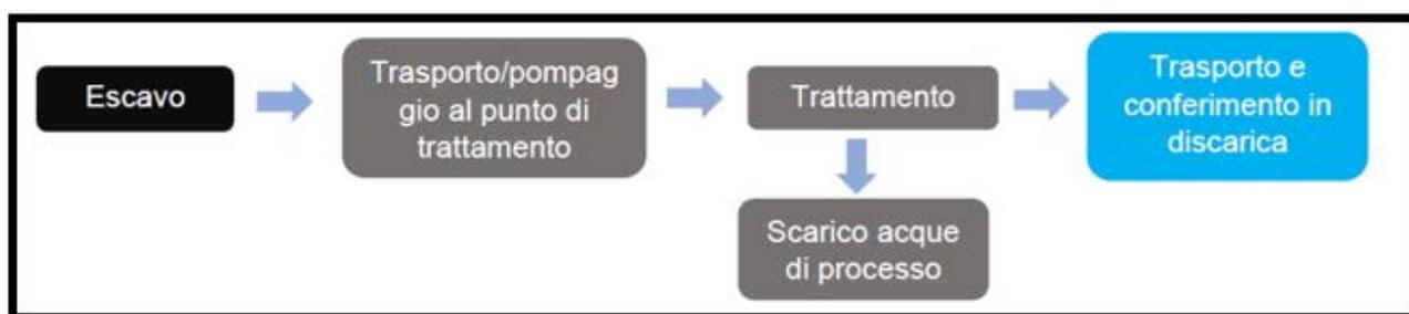
**Figura 12 - Schema delle fasi del ciclo di dragaggio.**
