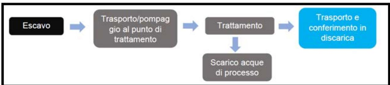
Figura 5: Schema fasi ciclo di dragaggio;
