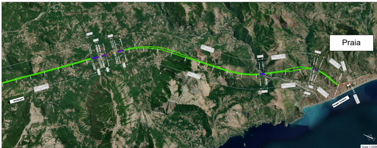
Figura 1-1 Inquadramento generale dell'area di intervento con indicazione del percorso della linea ferroviaria in progetto
