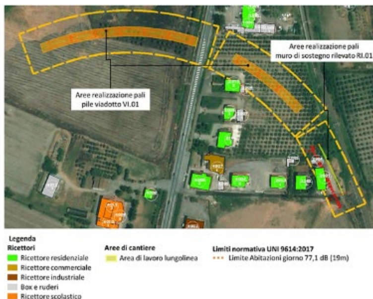
Figura 14: Ricettori potenzialmente interessati da potenziali disturbi legati alle attività di realizzazione delle opere
