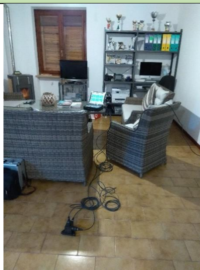
Posizionamento accelerometro monoassiale, 1° piano f.t.
