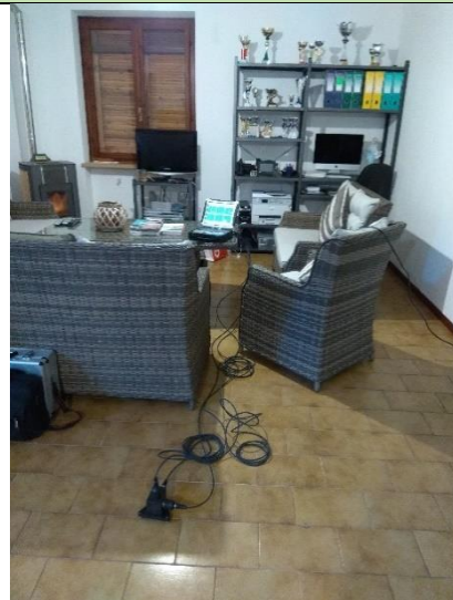
Posizionamento accelerometro monoassiale, 1° piano f.t.
