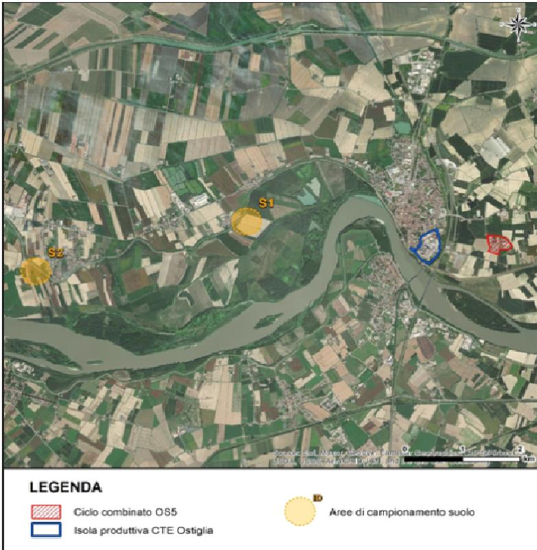
Figura 1 Punti di campionamento del suolo rispetto alla centrale
