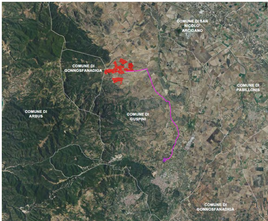
Figura 1 - Inquadramento territoriale dell'opera su ortofoto. Area di impianto (rosso), cavidotto (magenta), Stazione Elettrica (viola)
