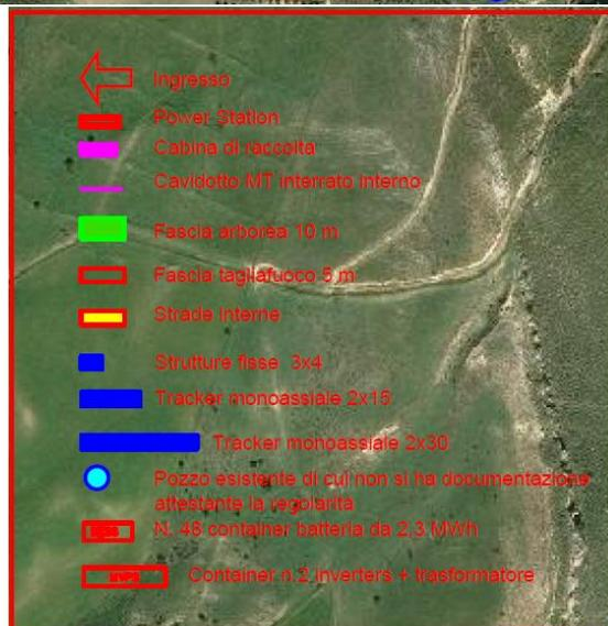
Figura 3 Componenti dell'impianto – Estratto dall'elaborato progettuale "Layout impianto"
