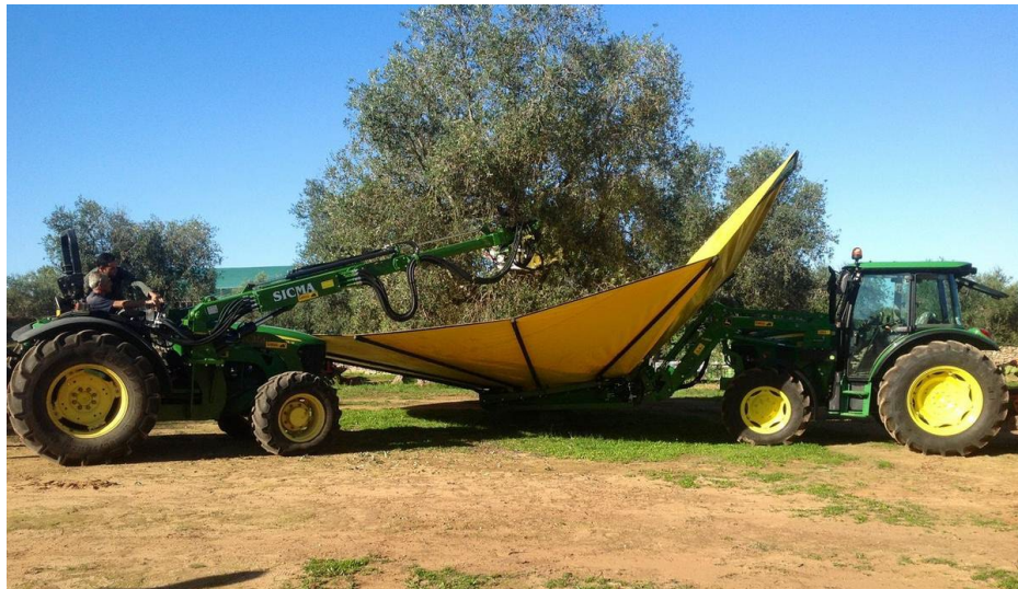
Fig. 13. Esempio di raccolta agevolata con scuotitrice ad ombrello rovesciato.
