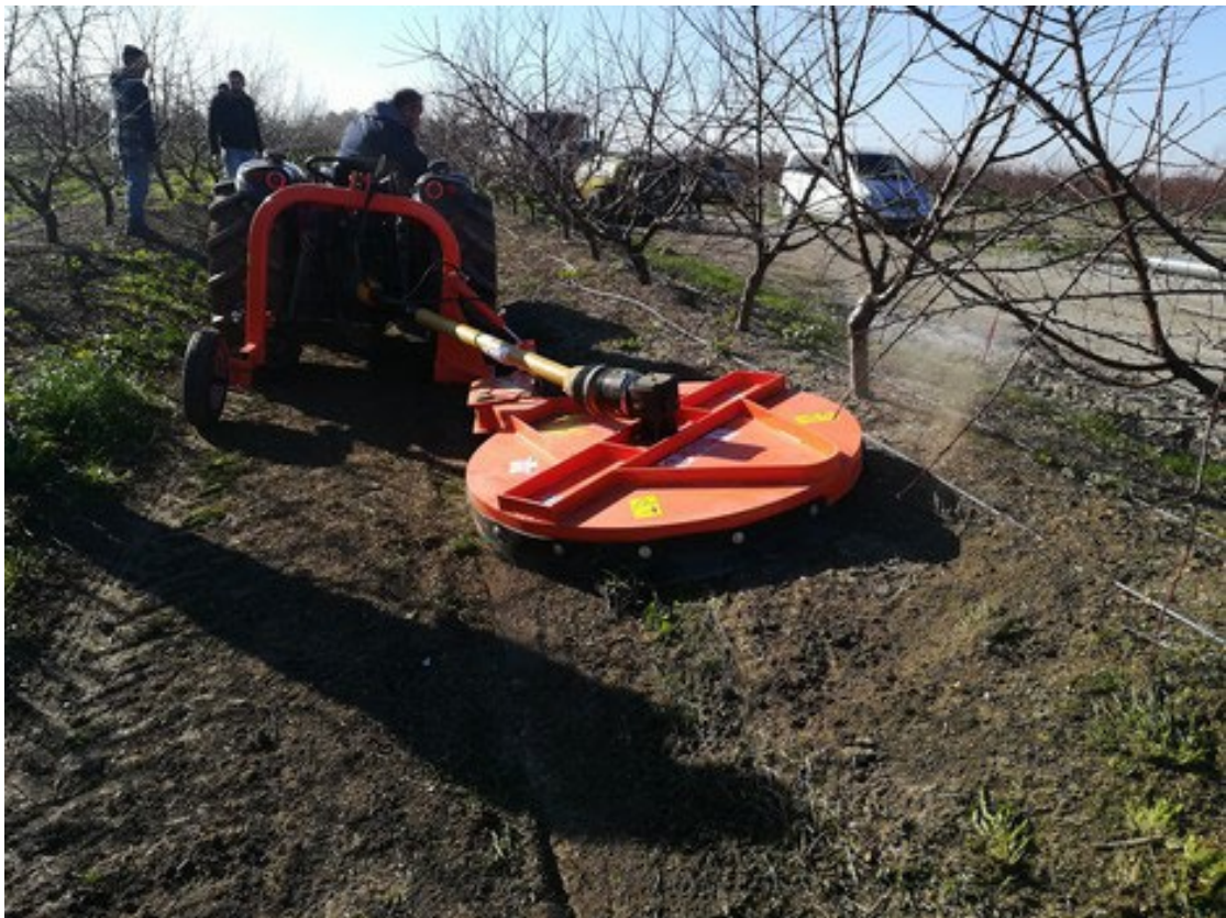
Fig. 12. Esempio di trinciatura su frutteto baulato
