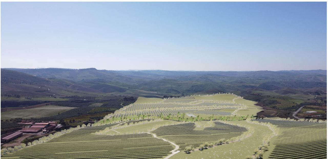
**Figura 5.30** Fotosimulazione vista dal lato Nord (scatto fotografico dal punto di vista PV02). E' visibile la fascia arborea di mitigazione che cinge tutto il perimetro dei blocchi dell'impianto per un'ampiezza di 10 m (la visibilità dei moduli fotovoltaici è trascurabile). Si può affermare che già dalla SS 117 bis e dalla SS 122 la visibilità, soprattutto della parte sud, sia bassa.
