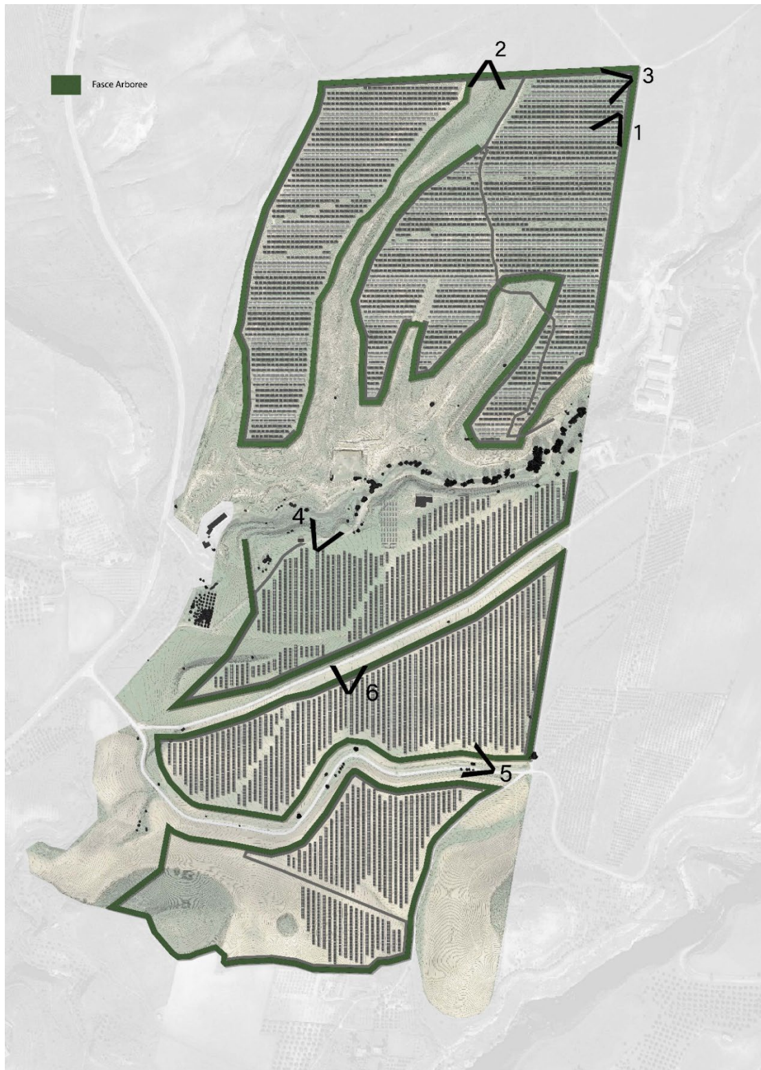
Figura 5-8 Rendering indicativo e vista dall’alto con distribuzione delle specie arboree costituenti la fascia di mitigazione perimetrale di ampiezza 10 m. Sono riportati anche i punti di vista PV01, PV02 e PV03 i cui scatti fotografici sono visibili nelle successive Figure.
