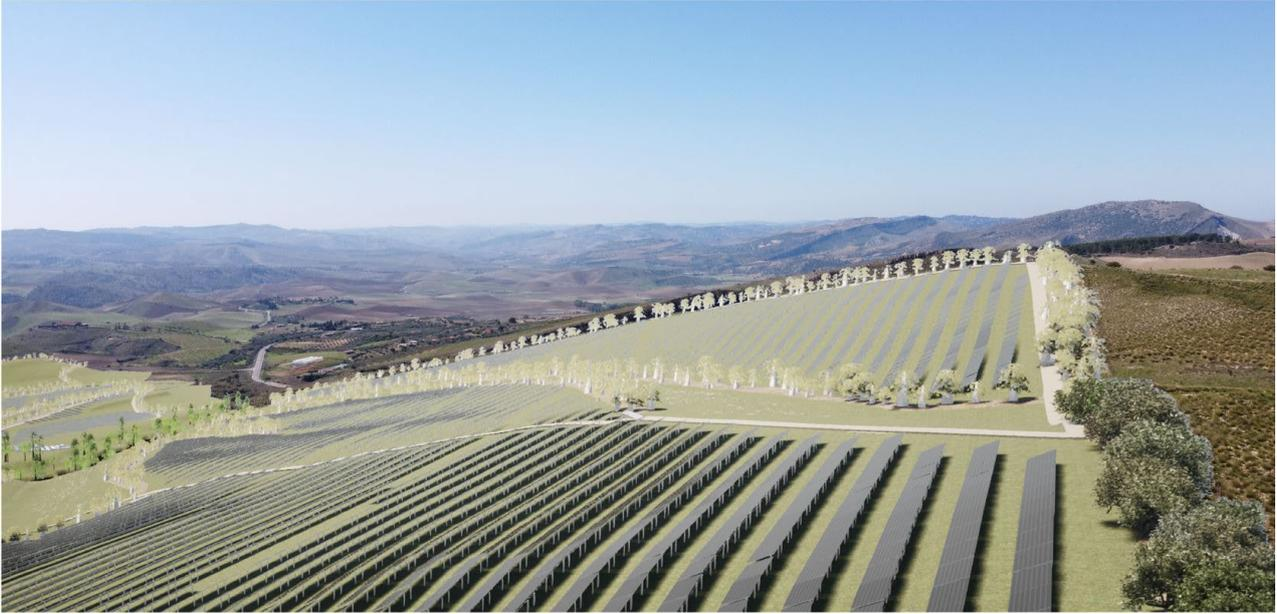
***Figura 27 - Fotosimulazione vista la Nord-Ovest (scatto fotografico dal punto di vista PV03). E' visibile esclusivamente la fascia arborea di mitigazione che cinge tutto il perimetro dei blocchi dell'impianto per un'ampiezza di 10 m (la visibilità dei moduli fotovoltaici è trascurabile). Si può affermare che già dalla SS 117 bis e dalla SS 122 la visibilità sia bassa.***
