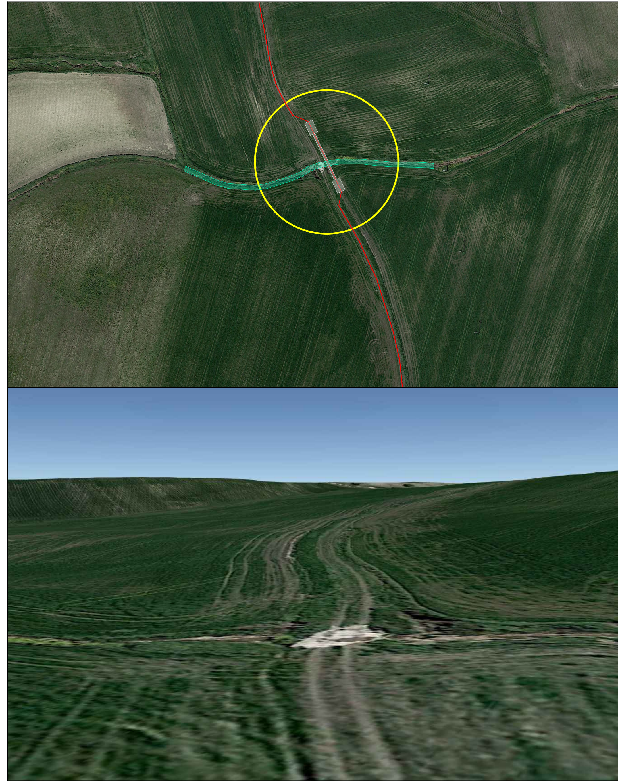
INTERF. n. 3 - S.C.Campo della fontana - Canale di irrigazione campi Lungh. foro di trivellazione = 20 m Diametro foro = 90 cm
