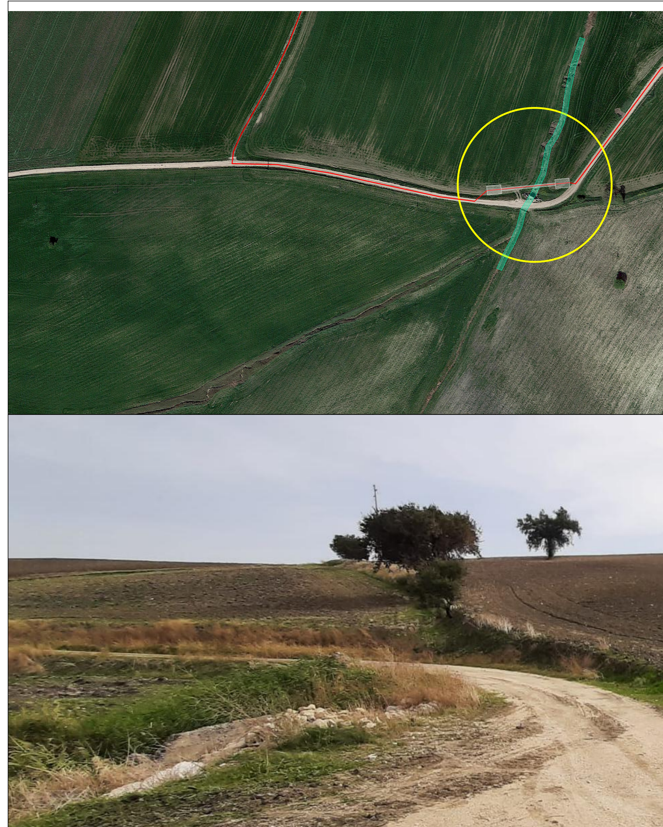
INTERF. n. 3 - S.C.Campo della fontana - Canale di irrigazione campi Lungh. foro di trivellazione = 20 m Diametro foro = 90 cm
