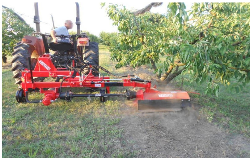
Figura 3-4. Fresatrice interceppo per le lavorazioni sulla fila (ditta Cucchi Macchine Agricole).
