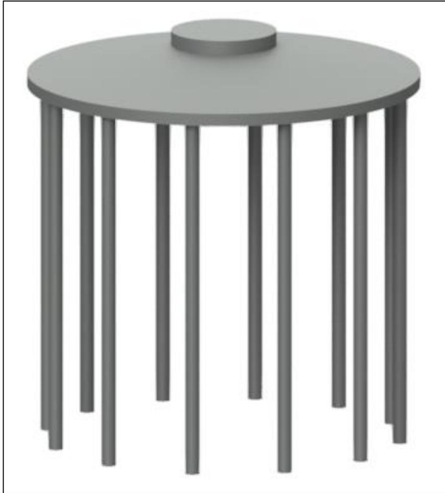
**Figura 9: vista tridimensionale della fondazione dell'aerogeneratore**
