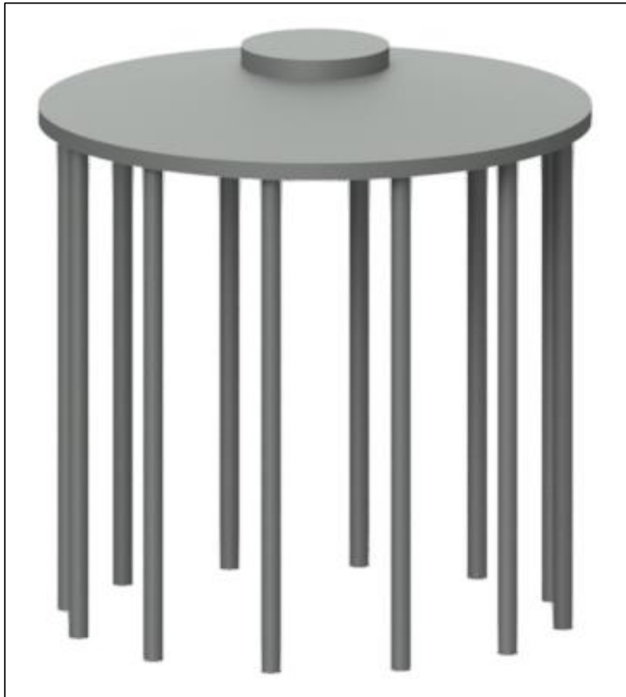
Figura 1: vista tridimensionale della fondazione dell'aerogeneratore
