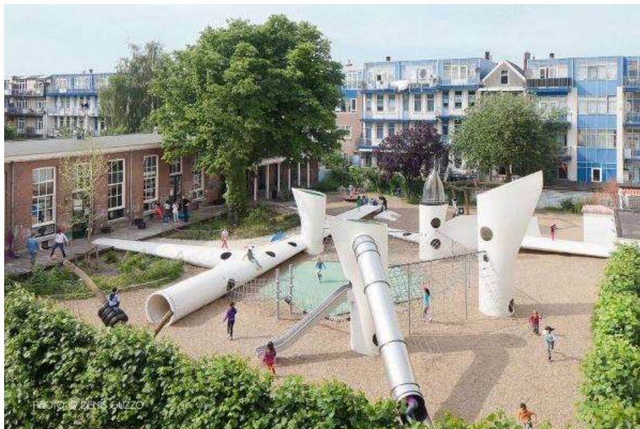
Figura 7: "Pale di turbine eoliche dismesse, riutilizzate in un parco giochi ", Kinderparadijs Meidoorn
