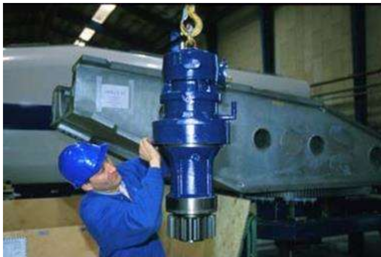
Figura 13: motori di giro e riduttori
