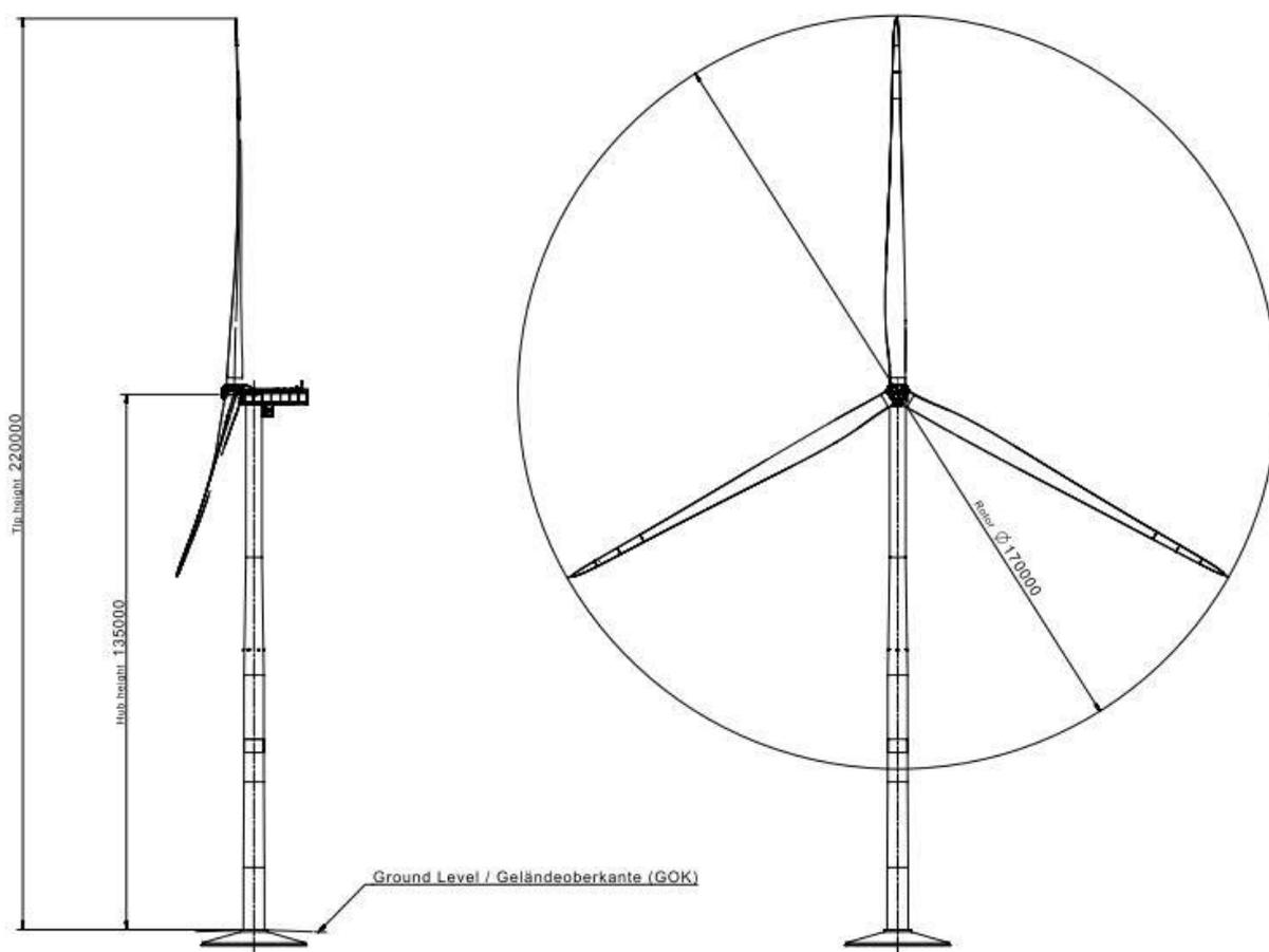
Figura 1. Vista aerogeneratore
