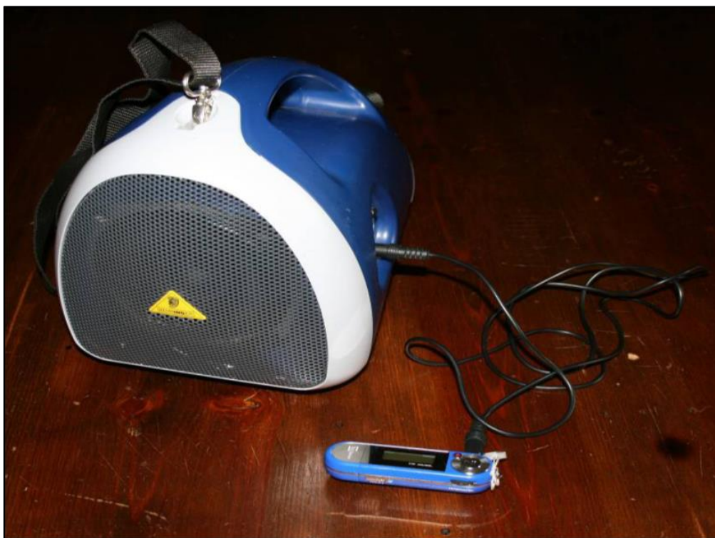
Figura 8 – Amplificatore collegato a un lettore audio MP3 utilizzato per i rilievi dei rapaci notturni
