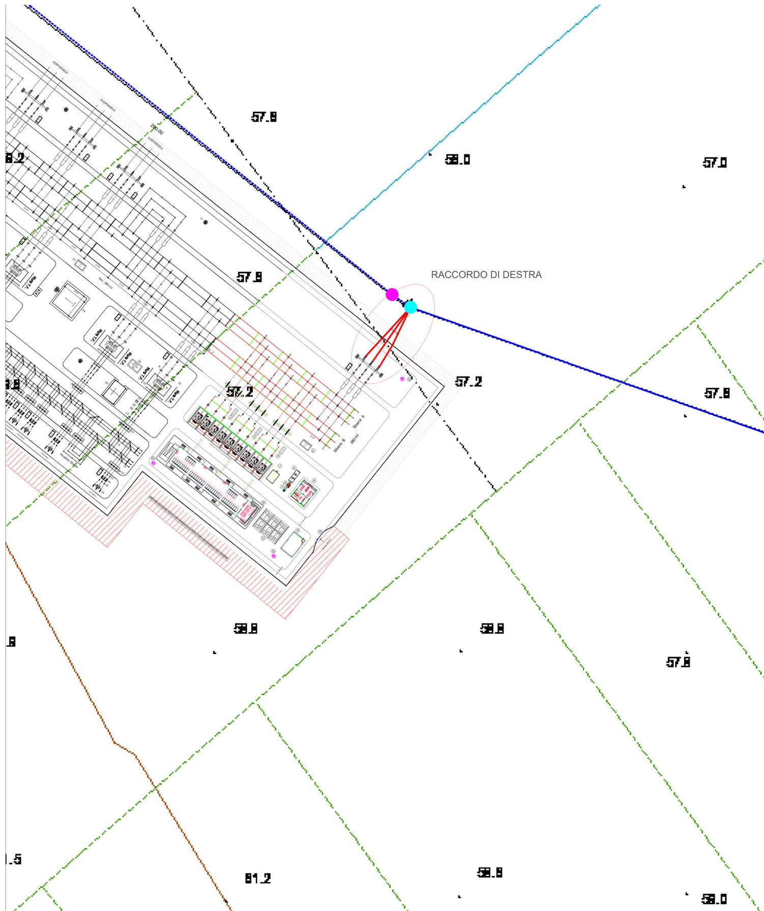
Il raccordo di sinistra mantiene le caratteristiche definite nel progetto autorizzato della sezione 380/150 kV già benestariata, e attraverserà le stesse particelle e terreni già previsti. Il raccordo di destra, come si vede in questo documento, ha un percorso più ridotto con il collegamento diretto della sezione a 380 kV alla linea Foggia-San Severo, pertanto non ci sono opere attraversate da segnalare
