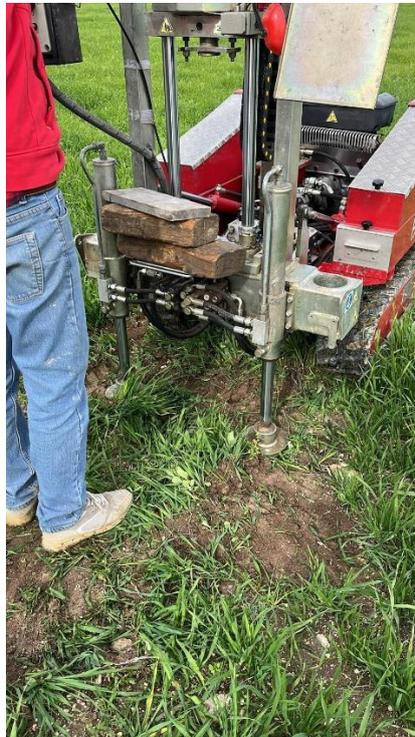
**FOTO N°19:** Prova penetrometrica dinamica DPSH n°4 - **AEROGENERATORE 7**
