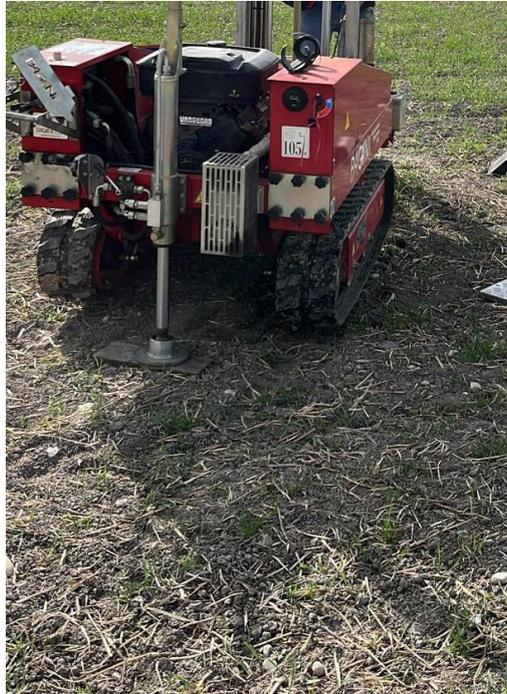
**FOTO N°13:** Prova penetrometrica dinamica [DPSH n°3](#) - AEROGENERATORE 4
