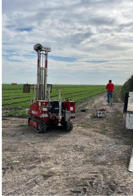
**FOTO N°9:** Prova penetrometrica dinamica [DPSH n°2](#) e stendimento sismico [MASW N°2](#)
