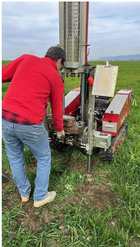
**FOTO N°22:** Prova penetrometrica dinamica [DPSH n°6](#) – SOTTOSTAZIONE
