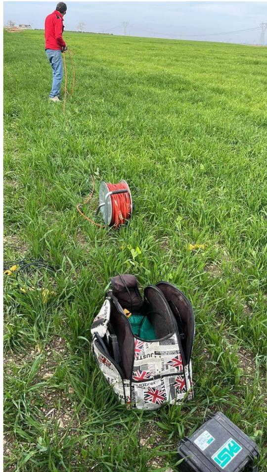
**FOTO N°23:** Stendimento sismico [MASW n°3](#)
