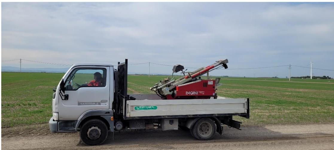
**FOTO N°18:** Approntamento cantiere prova **DPSH n°4** - **AEROGENERATORE 7**
