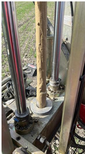
**Fig.16:** Dettaglio asta prova penetrometrica n°1. Presenza di acqua in concomitanza con il livello sabbioso limoso
