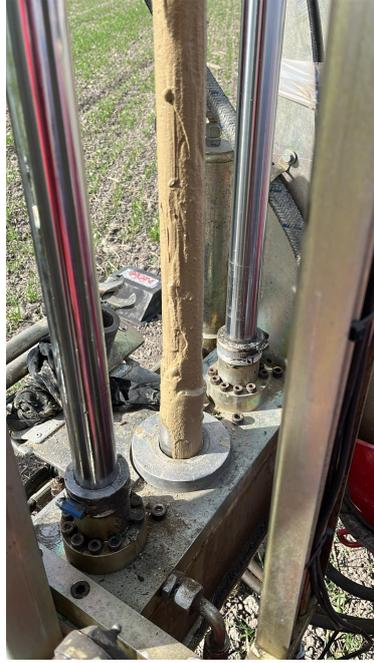
**Fig.12:** Dettaglio asta prova penetrometrica n°1. Presenza di acqua in concomitanza con il livello sabbioso limoso
