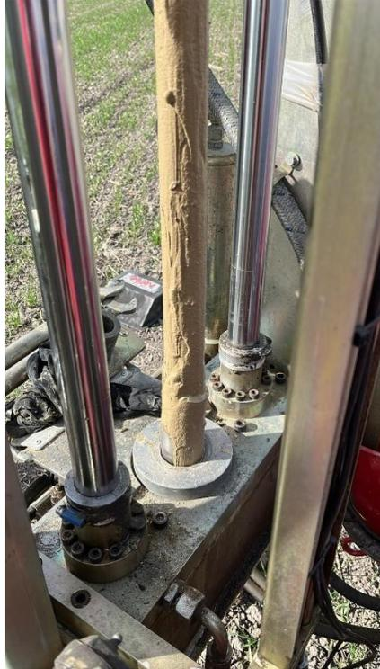
**FOTO N°3:** Dettaglio aste DPSH, presenza di limi sabbie e acqua
