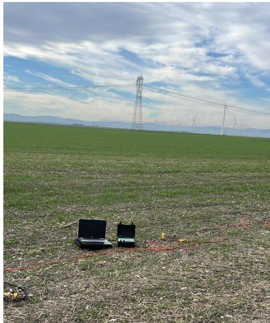
**FOTO N°5 -6:** Indagine sismica [MASW N°1](#) con 12 geofoni verticali
