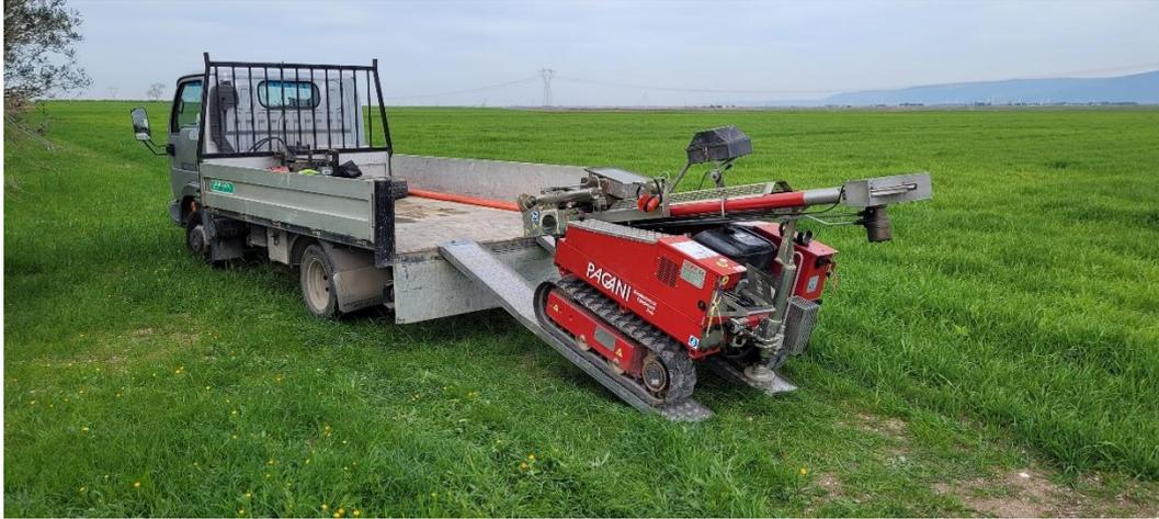
**FOTO N°21:** Approntamento cantiere prova [DPSH n°6](#) – SOTTOSTAZIONE
