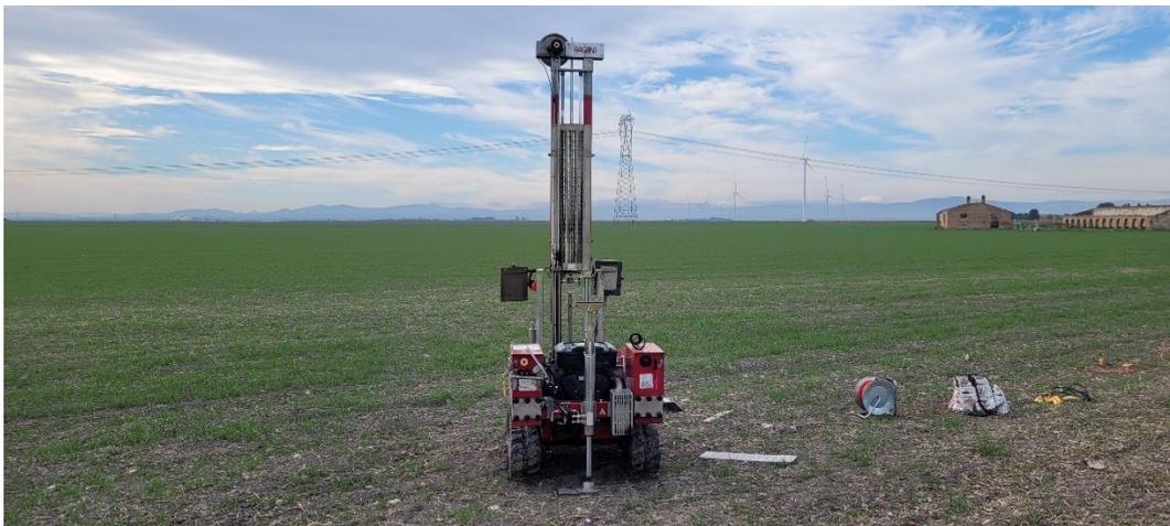
**FOTO N°2:** Prova penetrometrica dinamica **DPSH n°1** e stendimento sismico **MASW N°1**
