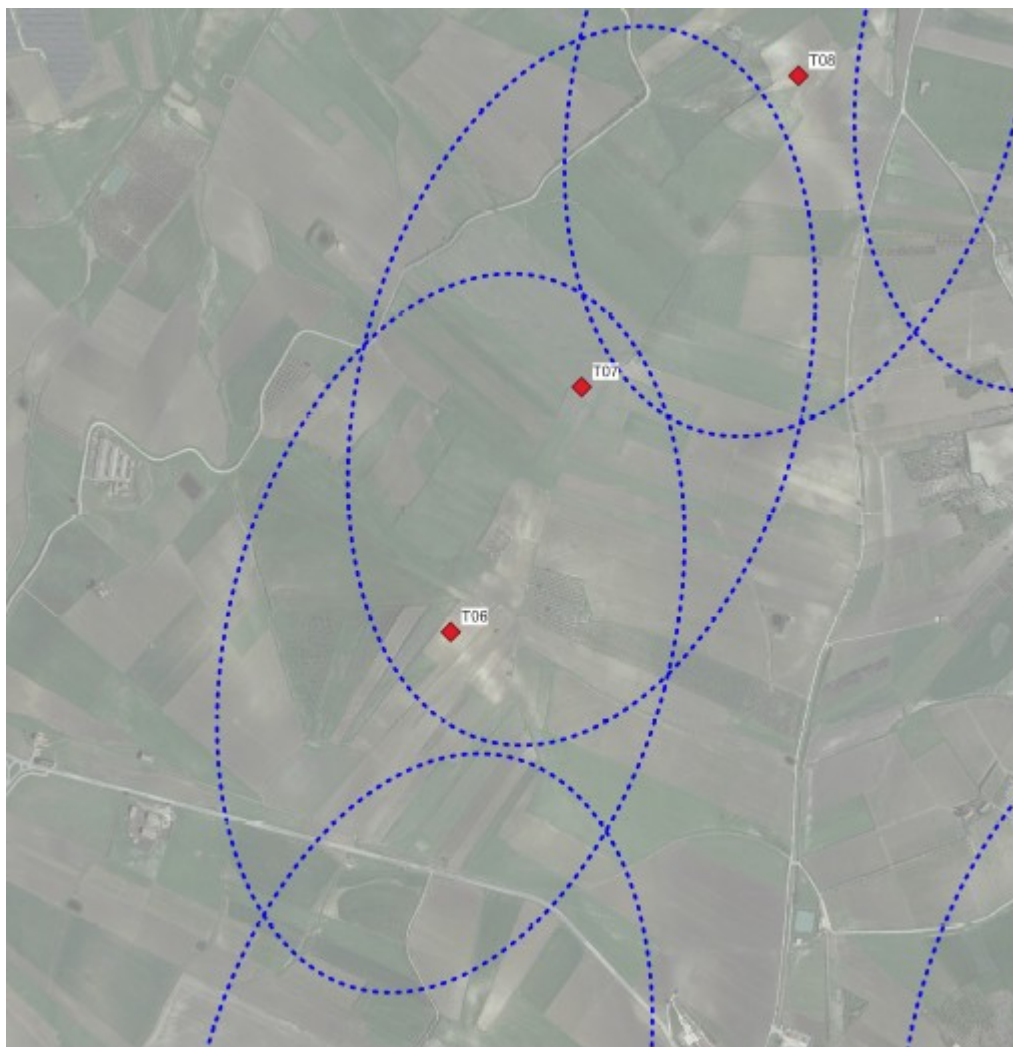
Figura 16: Estratto dall'elaborato "Planimetria con indicazione delle distanze 3D e 5D. le turbine T05 E T06 si trovano ad una distanza inferiore al minimo
