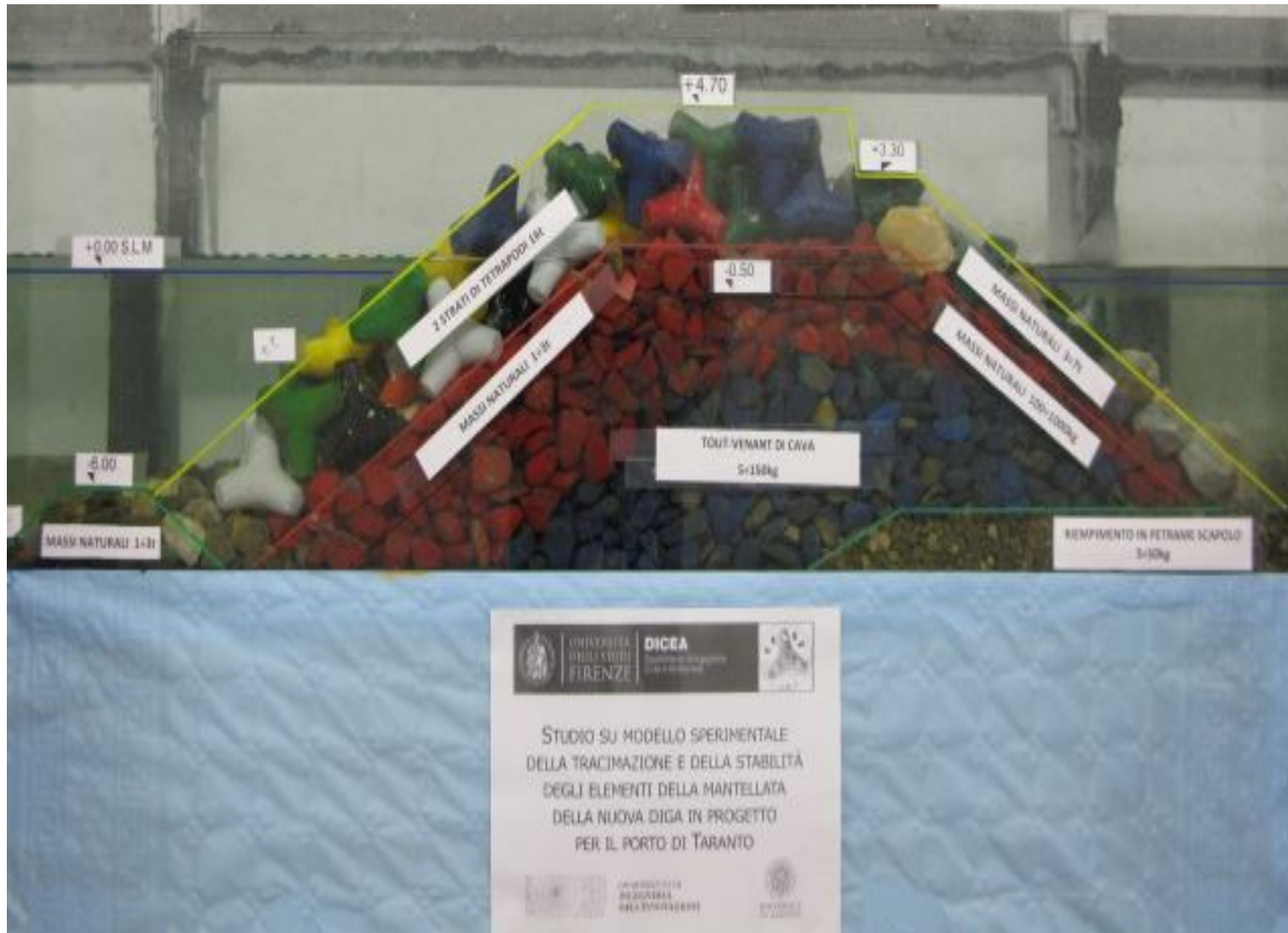
Figura 14 (b): Immagine del modello realizzato: sezione "250-seconda variante"
