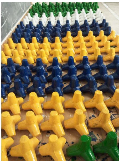
Figura 9: Tetrapodi utilizzati per la realizzazione della mantellata
