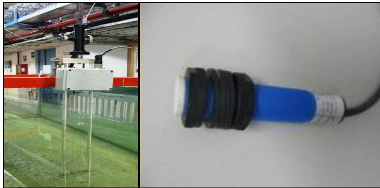
Figura 6: sensori per la misura dei moti ondosi; a sinistra una sonda resistiva a destra una sonda ad ultrasuoni
