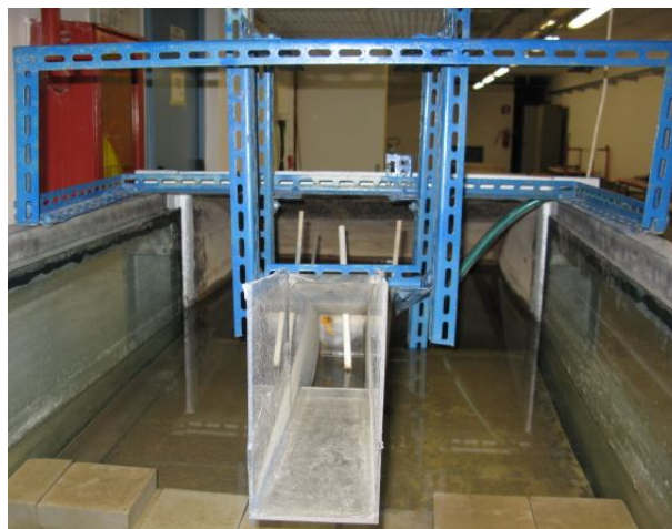
Figura 7: Campionatore delle portate di overtopping
