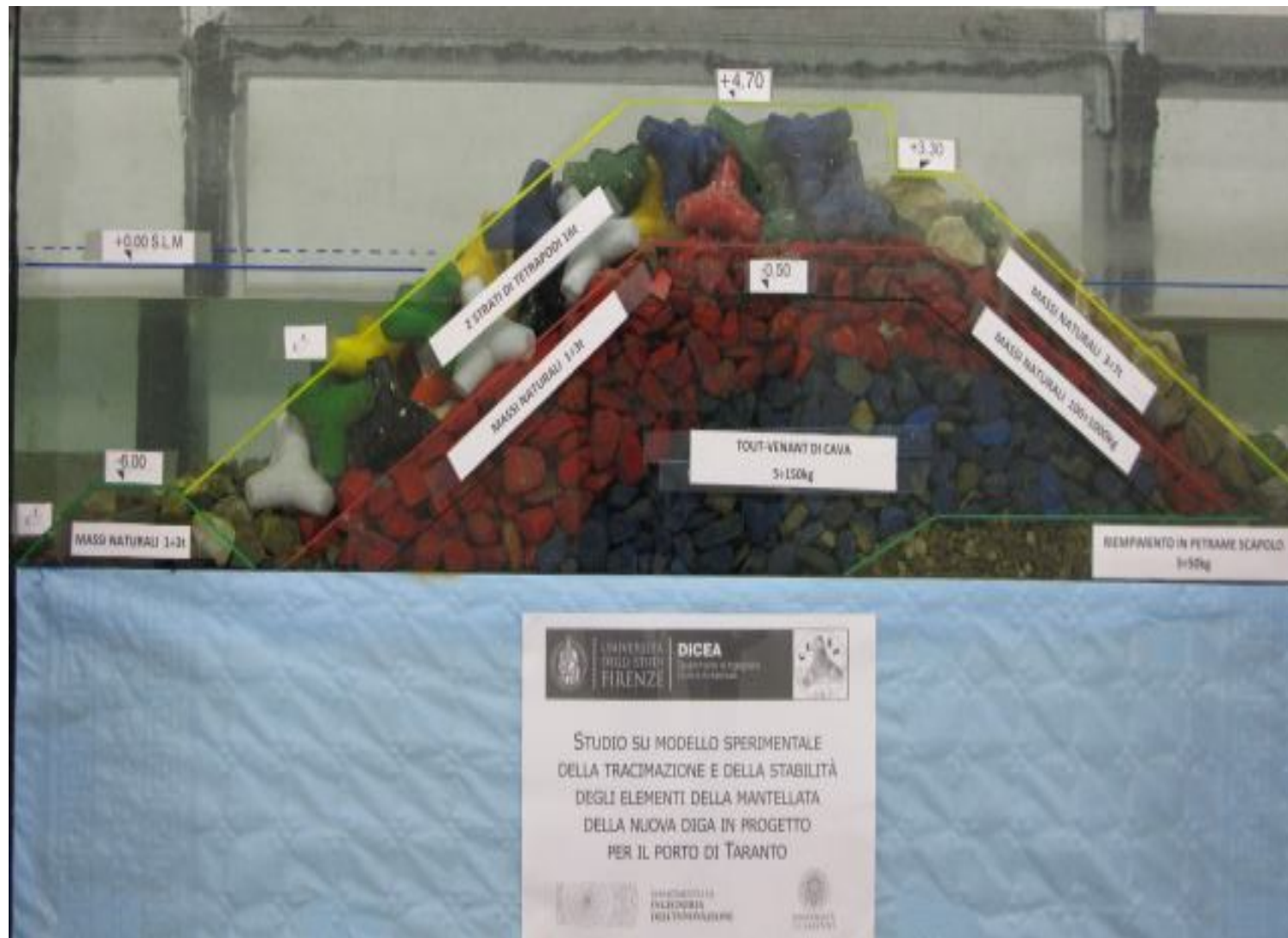
Figura 14 (a): Immagine del modello realizzato: sezione “250-prima variante”
