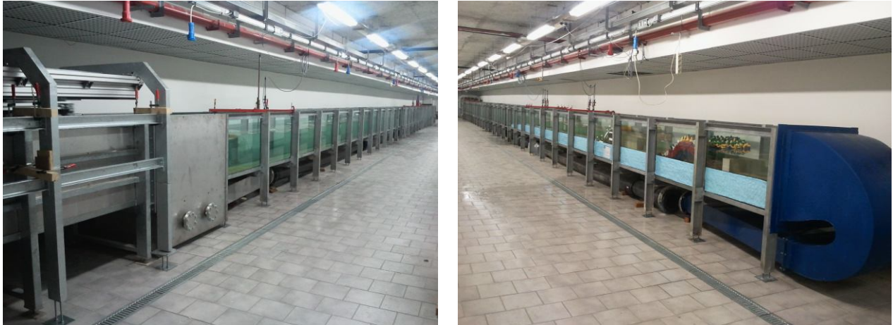
Figura 4: Il canale del CoastLab - Laboratorio di Ingegneria Marittima del DICEA
