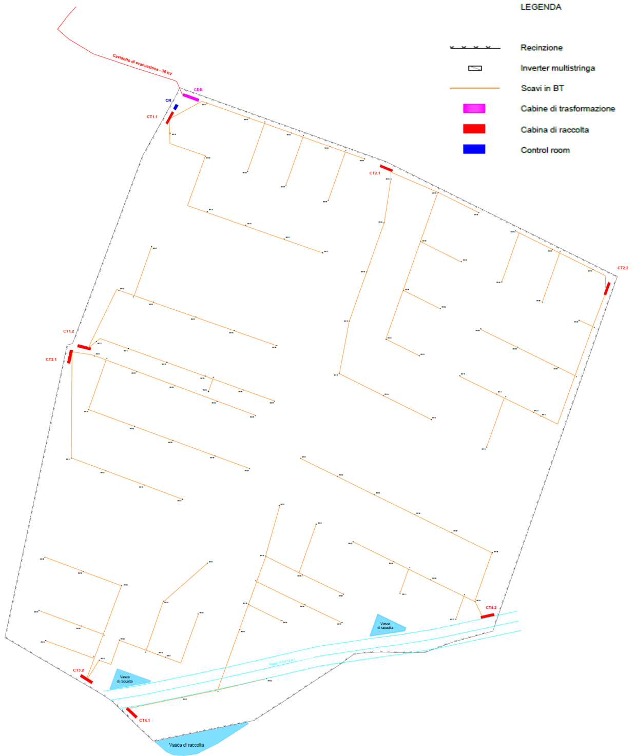
Figura 3.7: Tracciato degli scavi di connessione tra gli inverter e le cabine di trasformazione
