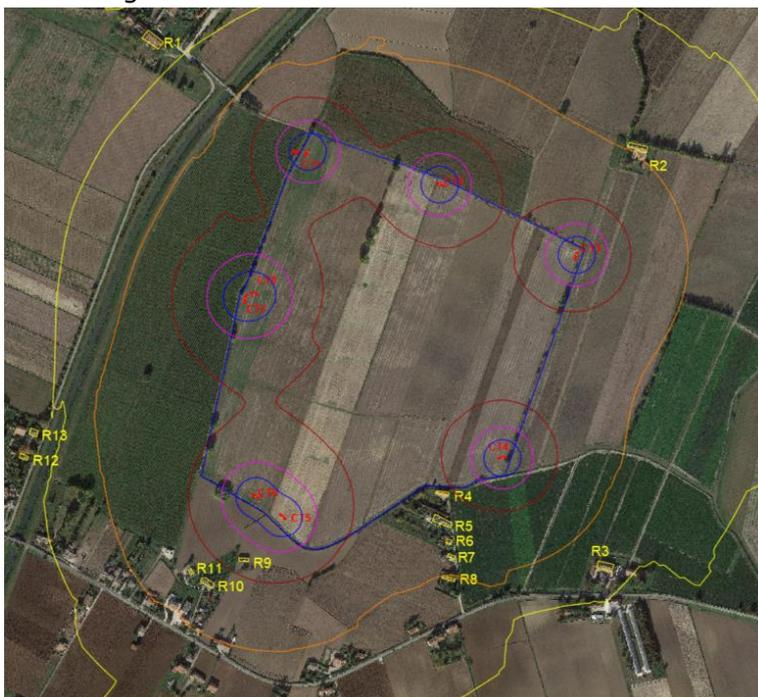
Figura 5 – Risultato della simulazione con linee di iso-rumorsità colorate da 15 dB (gialla) a 35 (blu)
