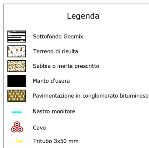
Figura 11 – Materiali di riempimento per scavo cavi esterni
