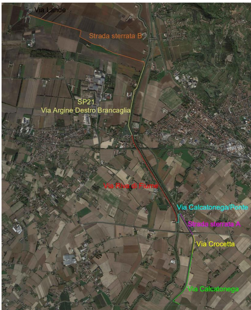
Figura 10: Inquadramento su ortofoto del percorso del cavidotto e dei relativi percorsi stradali
