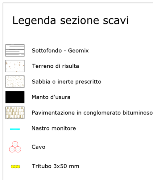
Figura 9: Materiali di riempimento per tipologia di scavo
