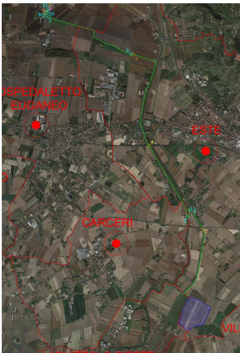
Figura 11: Inquadramento su ortofoto: area d'impianto (blu), confini comunali (in rosso), percorso del cavidotto (in verde), Stazione Terna (in magenta), e interferenze (in azzurro gli i fossi/corsi d'acqua, in arancione i gasdotti e in giallo le linee ferroviarie).
