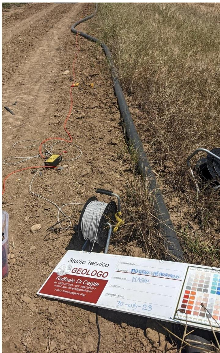
Figura 9-16. Stendimento con apparecchiatura DoReMi.
