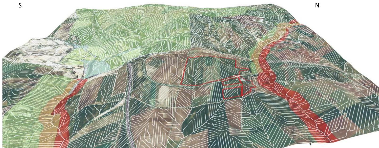
Figura 4-2. Elaborazione tridimensionale, in ambiente QGis, del deflusso superficiale (linee bianche). In trasparenza: in verde, l'area soggetta a vincolo idrogeologico (PPTR); in celeste, Pericolosità idraulica (P.A.I.); in rosso, Reticolo idrografico di connessione della R.E.R. (100 m).
