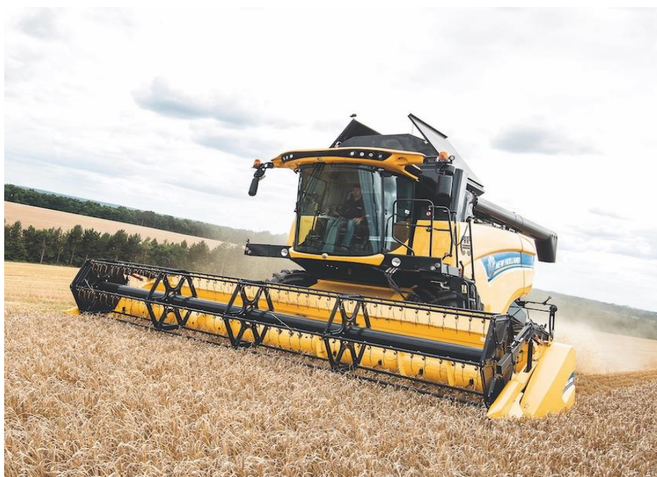
Figura 3-9. Mietitrebbia operante su pendenza trasversale (NewHolland).
