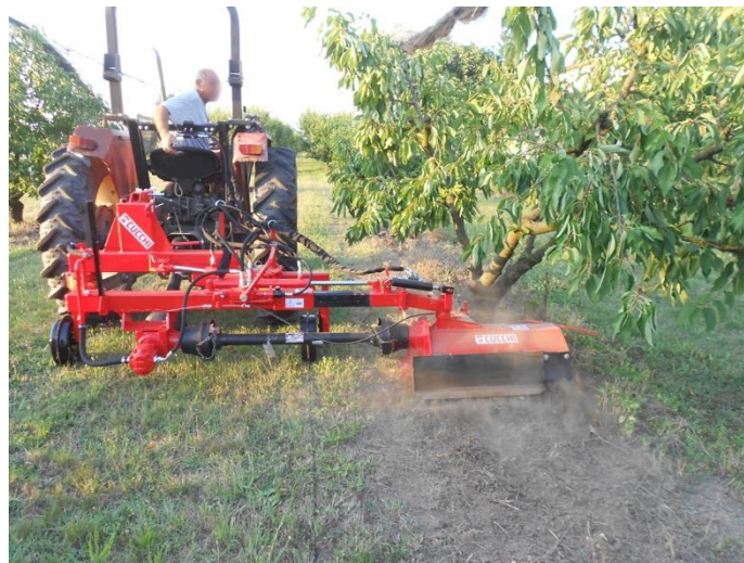
Figura 3-7. Fresatrice interceppo per le lavorazioni sulla fila (Cucchi Macchine Agricole).
