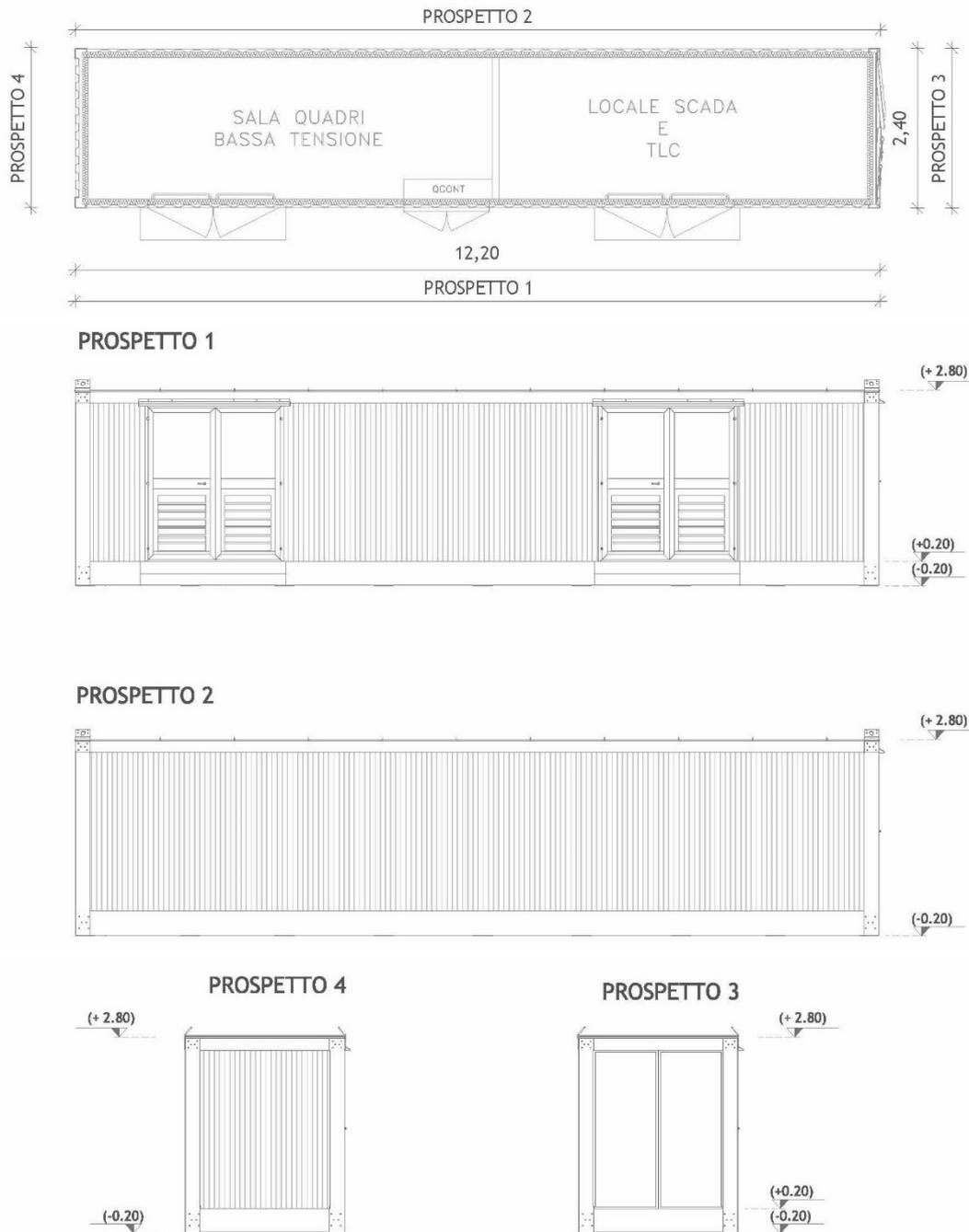
Figura 12 – Planimetria e prospetti dell’Edificio BT + SCADA e TLC
