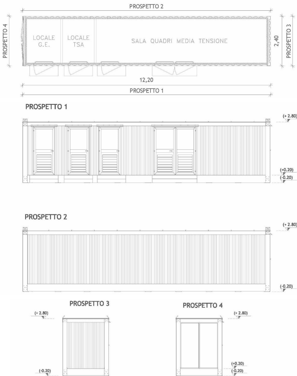
Figura 11 – Planimetria e prospetti dell'edificio quadri
