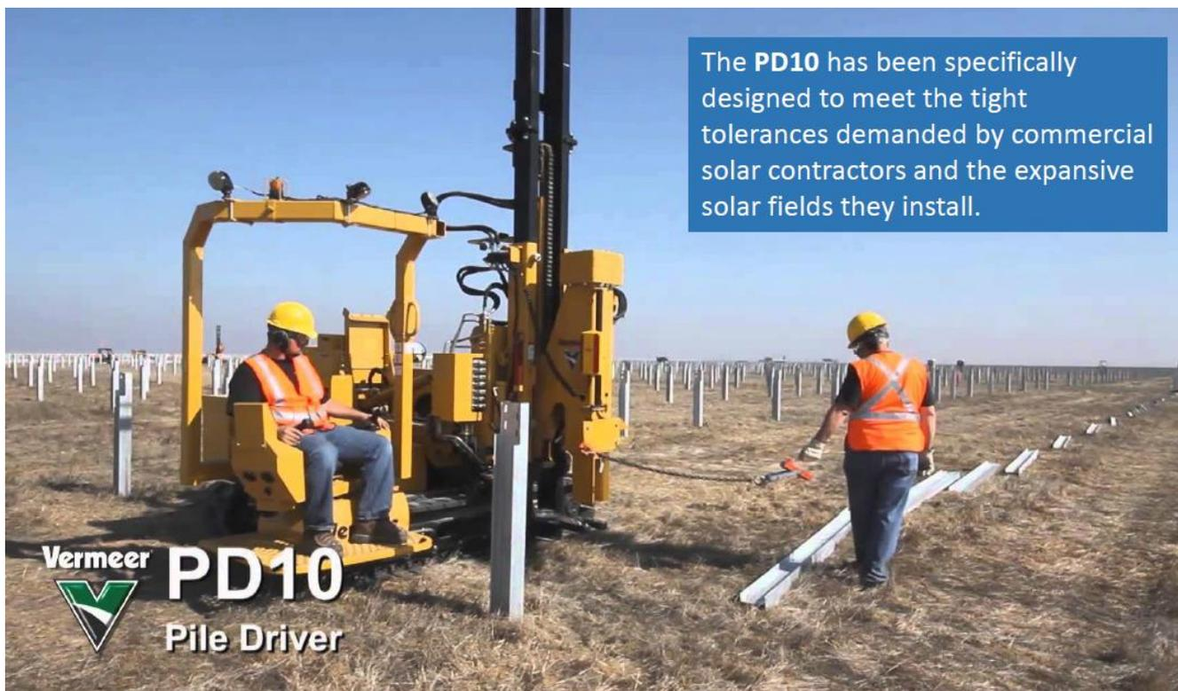
*Fig. 30: Macchina battipalo (esempio)*
