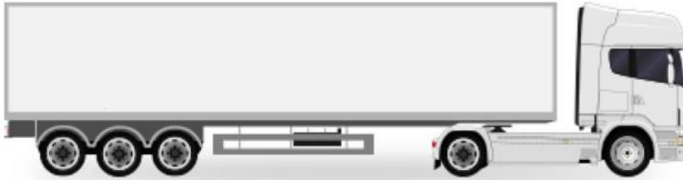
Fig. 3: Camion da 24 tonnellate (autocarri telonati, autoarticolati)
