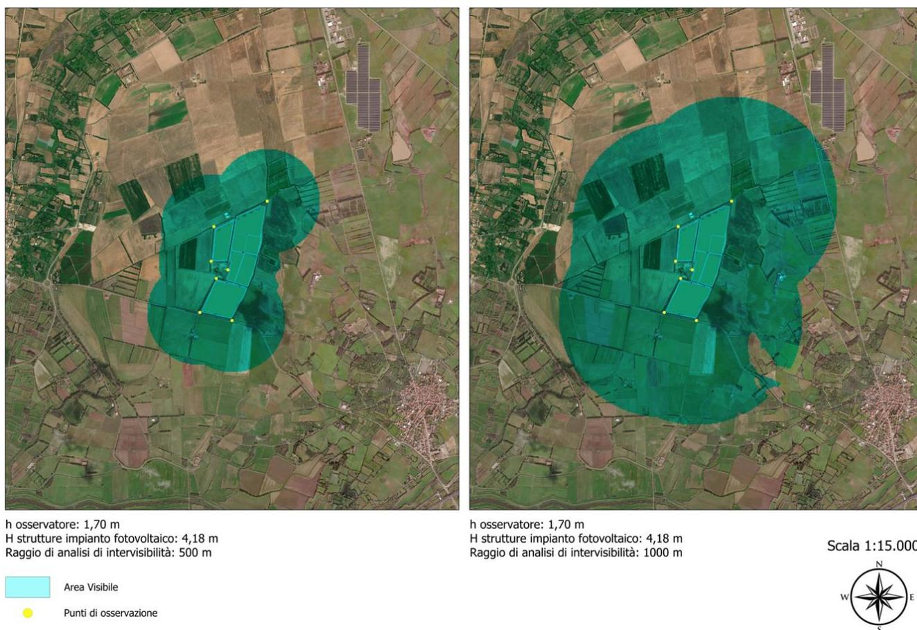
Fig.69: **Intervisibilità** con osservatore  $h = 1,7m$  e pannello in tilt a  $60^\circ$  est-ovest  $h = 4,18m$  1: 15.000
