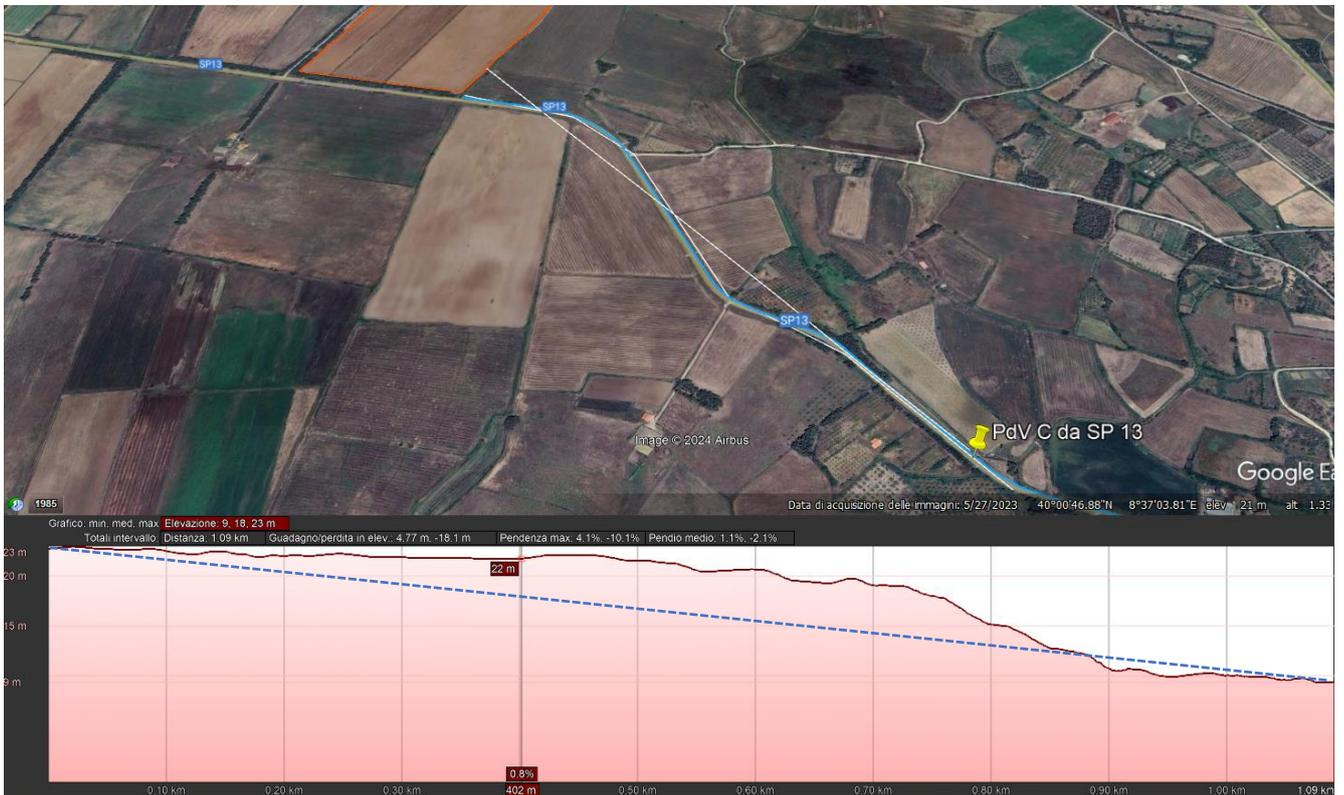
*Fig. 63: Profilo altimetrico della linea visiva di collegamento tra la corsia Nord della SP13 in direzione San Vero Milis e il sito d'impianto – distanza 1,1 km*
