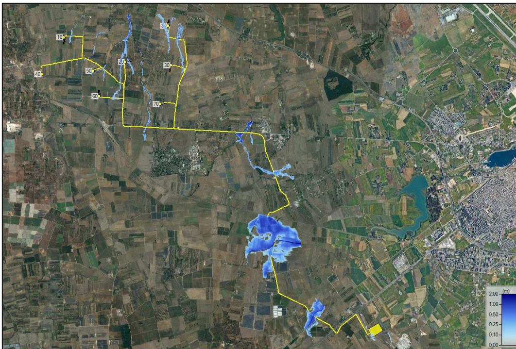
Figura 4 – Vista complessiva delle aree inondabili, desunta dallo studio idraulico
